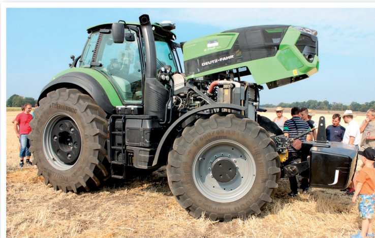
Kapota motoru se zvedá na čtyřech bodech, což zlepšuje přístup k motoru
