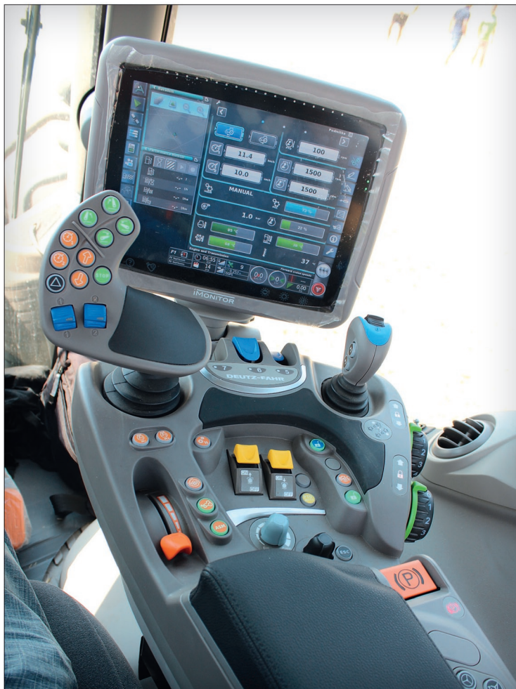
Většina ovládacích prvků je umístěna v komfortní loketní opěře
