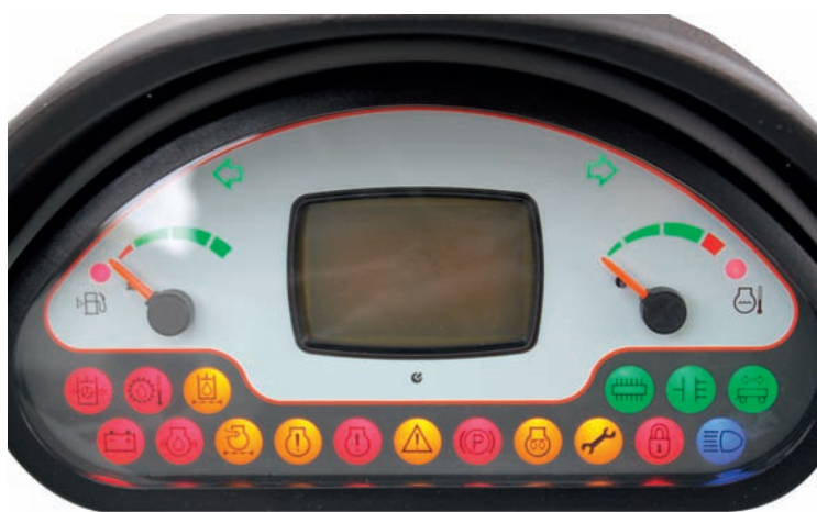
Přístrojová deska obsahuje LCD displej a nezbytné kontrolní svítivky
