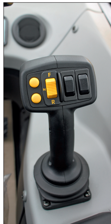
Pomocí joysticku se ovládají všechny funkce teleskopického ramene, ale též mění směr jízdy a řadí převodové stupně
