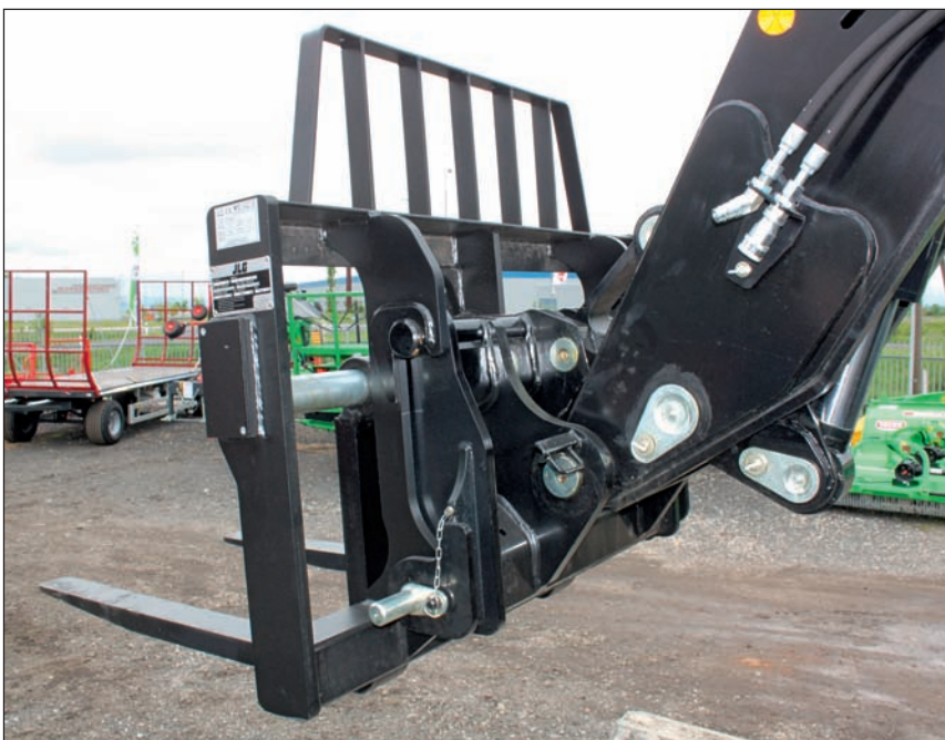
Ovládání adaptéru přes Z kinematiku znamená zvýšení trhací síly
