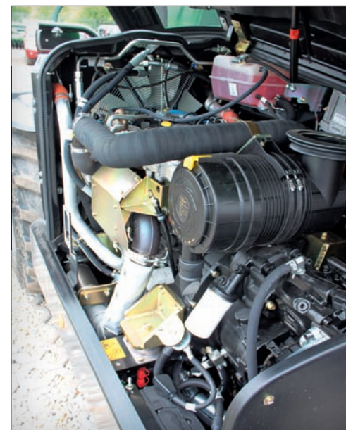
Motor Deutz je vybaven vstříkáním Common Rail a obejde se bez SCR či filtru částic
