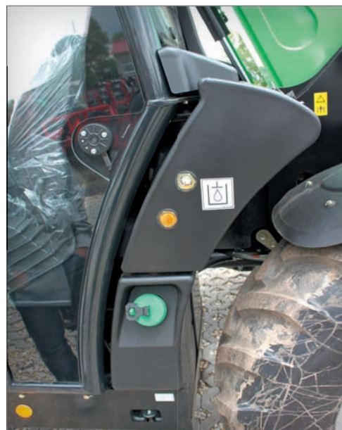
Jednoduchou kontrolu stavu hydraulického oleje dovolují průhledy v nádrži
