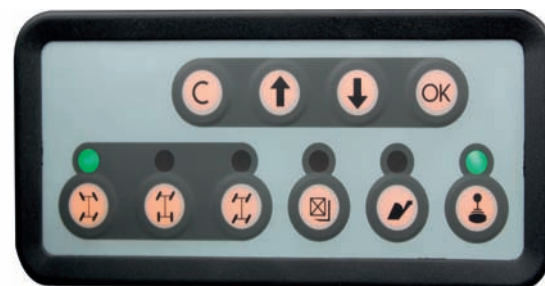
Pomocí fóliových tlačítek se komfortně mění režimy řízení (první tři tlačítka zleva) a pohybu adaptéru (další dvě tlačítka s příslušnými symboly)
