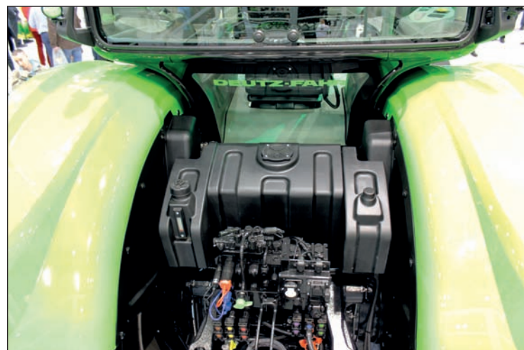
Na obrázku je nápadně kompletní oddělení kabiny od blatníků a posunutí od zadní nápravy daleko dopředu. Tato opatření mimo jiné přispívají ke zvýšení pohodlí za jízdy
