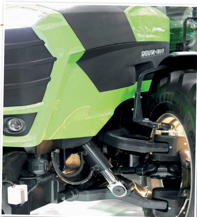
Pro spolehlivý přenos výkonu a pohodlnou jízdu vyvinuli konstruktéři nezávislé zavěšení kol přední nápravy
