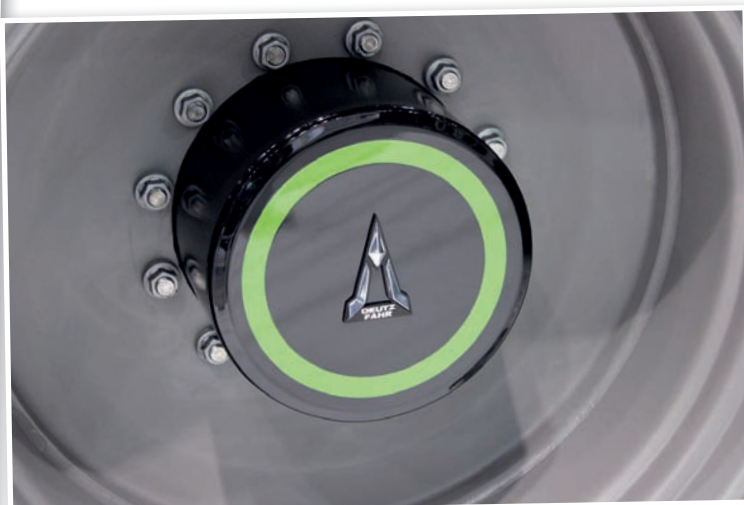
Robustní nápravy a počet šroubů pro uchycení ráfku odpovídají předpokládanému vysokému zatěžování. Rovněž nosnost pneumatik Michelin AxioBib je vysoká
