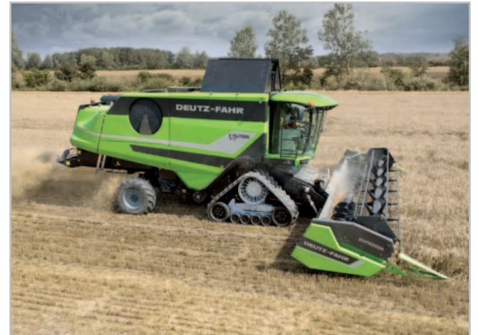
Sklízecí mlátička C9206 vybavená odpruženým pásovým podvozkem při sklizni obilí Foto archiv firmy
