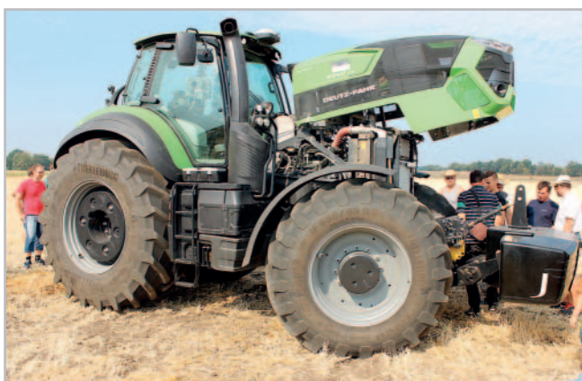
Kapota motoru se zvedá na čtyřech bodech, což zlepšuje přístup k motoru
